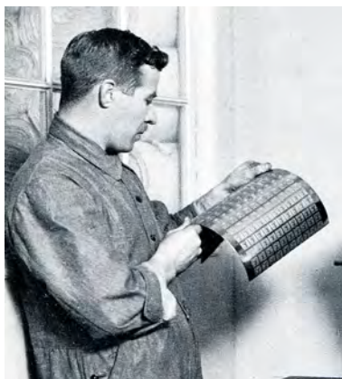
Plåten bockas till en halvcylinder.
