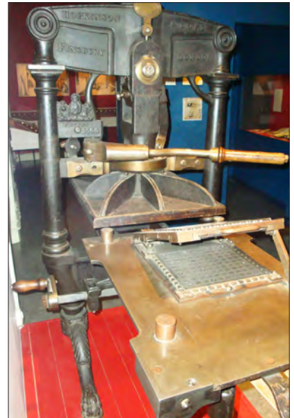
Perforeringsverktyg monterat i Sparres digelpress (Postmuseum).
