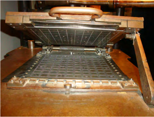
Samma typ av arkperforeringsverktyg användes mellan 1855 och 1912. Bild: Postmuseum.
