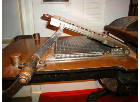
Perforeringsverktyget "våffeljärnet" sett från sidan (Postmuseum).
