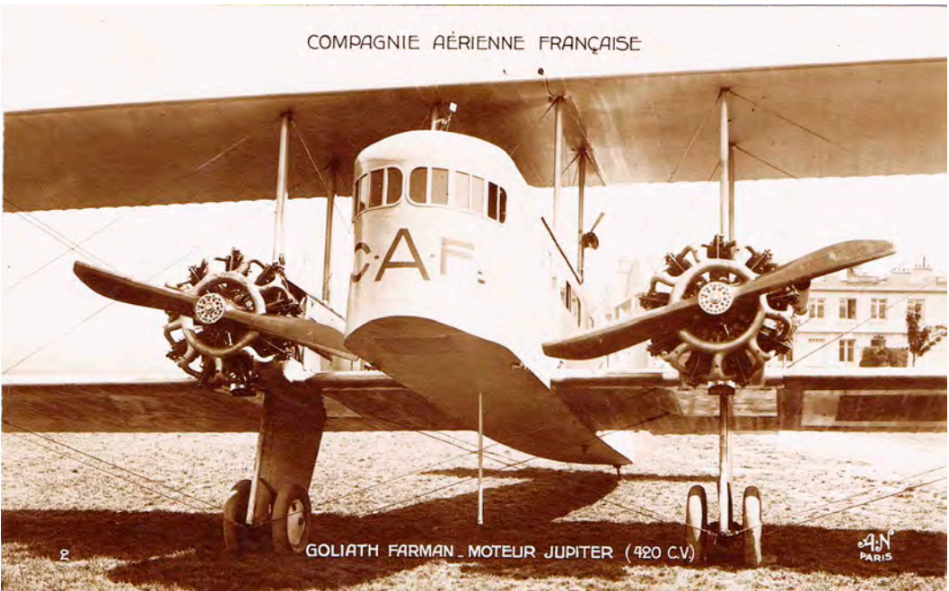
Detta fina vykort visar i närbild den aktuella flygplanstypen som avbildas på flygbiljetten. Det är det tvåmotoriga Farman-tillverkade planet Goliath som kunde ta 12–16 passagerare, med 9-cylindriga stjärnmotorer och träpropellrar, och inte att förglömma den fantastiska strömlinjeformade profilen!
