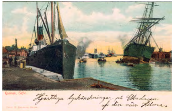
Gävle hamn 1904, och på högra sidan syns ett segelfartyg som kölhalas, det vill säga att man via tågvirke fäst i riggen vinschar ner fartyget i nästan liggande ställning för att på detta sätt komma åt att reparera eller underhålla skrovet.
