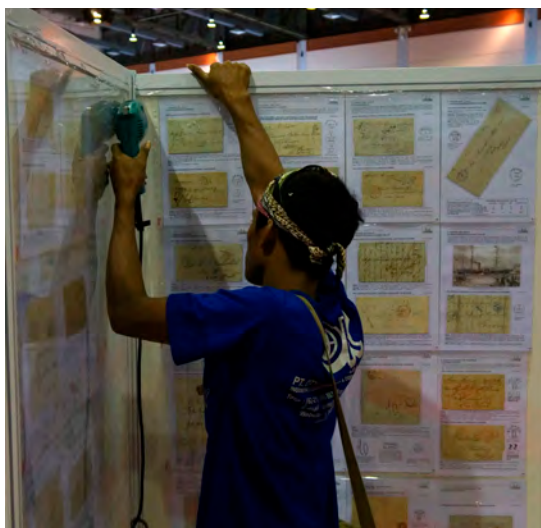
Indonesisk utställningsarbetare sätter ihop ramarna genom att med bormaskin borra hål genom ramarna för att fästa ihop med buntband. Notera att exponatet sitter uppe i ramen. Foto: Jonas Hällström
